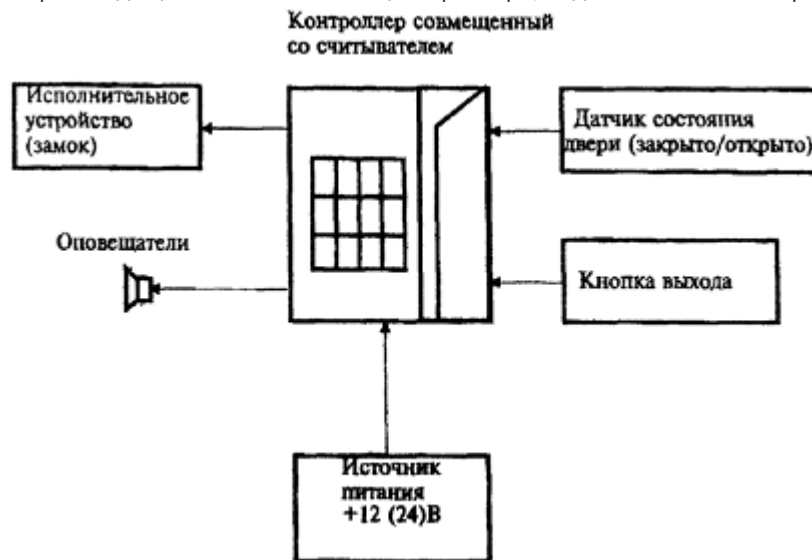
Рисунок 1 - Оборудование СКУД помещения с одной дверью
