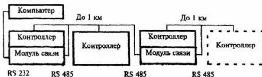
Рисунок 6 - Увеличение длины ветви при использовании двух модулей связи
